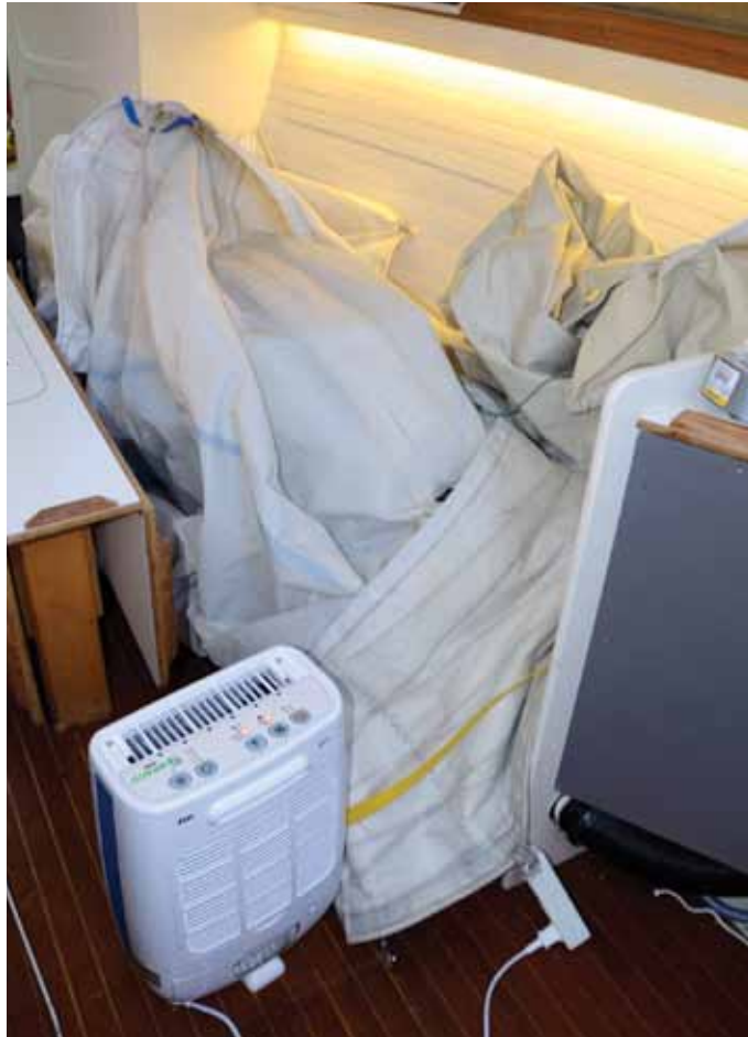
SKUFF: Når skuffen som samler opp fuktigheten i Meaco-avfukteren er full, stopper maskinen.
