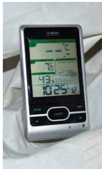
KONTROLL: Et hygrometer forteller deg hvor fuktig luften er.
