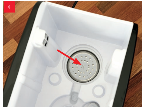
Legg A451 anti-kalk-pute i fordamperskålen.
